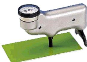
La mesure est basée sur la pénétration, dans l'échantillon, d'un cône tronqué sur laquelle est exercée un effort constant. La dureté est fonction de cet enfoncement. Le cadran indicateur possède 100 échelons, chacun représentant une profondeur de pénétration de 0,0076 mm. Ainsi plus la valeur lue sur le cadran est élevée, plus le matériau est dur.
